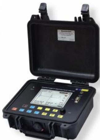
Рефлектометр импульсный **TDR-107 «СТРИЖ-С»** – цифровой рефлектометр, специально разработанный для определения расстояний до любых типов неоднородностей и повреждений в силовых кабельных линиях (КЛ): обрыв, короткое замыкание, муфта, сростка кабеля, параллельный отвод, замокание кабеля. Реализация дополнительных высоковольтных методов позволяет определять на силовых КЛ высокоомные повреждения, заплывающий пробой и пр.
