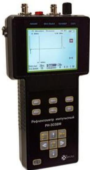
РИ-303ВМ СТРИЖ - компактный защищённый рефлектометр-тестер. Это простой в управлении и надёжный прибор, с автоматической защитой от напряжения в КЛ. Оптимальное решение для оперативного поиска неисправностей и измерения длины кабеля.
