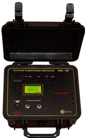
Компактный генератор ИЗИ-100 в ударопрочном, пыле-влагозащищенном переносном корпусе применяется в полевых условиях для подачи в подземные коммуникации сигнала, необходимого для их идентификации приемником-трассоискателем. Благодаря повышению контролируемой выходной мощности до 100 Вт, ИЗИ-100 позволяет локализовать пробой кабеля типа "жила-жила" или "жила-броня", а также обнаружить повреждение со значительным сопротивлением утечки.
